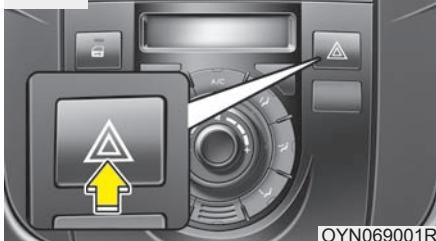
Включение световой аварийной сигнализации производится нажатием на соответствующую кнопку. В результате начинают мигать все указатели поворота. Система аварийной сигнализации работает, даже если в замке зажигания нет ключа.
