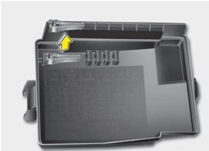
3. Извлеките сомнительный предохранитель, потянув его вверх, вертикально, под прямым углом к блоку предохранителей. Используйте съемник, который находится в крышке панели предохранителей в отсеке двигателя.
