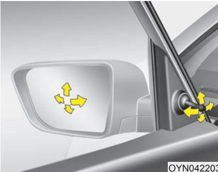
**Дистанционное управление****Зеркало с ручным механизмом складывания (при наличии)**
