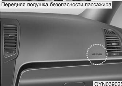
На ее наличие указывает рельефная надпись AIR BAG (ПОД. БЕЗОП.) на крышке подушки безопасности на рулевом колесе и на элементе передней панели над перчаточным ящиком со стороны пассажирского сиденья.
