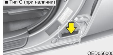
На табличке сертификации автомобиля (которая находится на средней стойке со стороны водителя или пассажира) имеется идентификационный номер автомобиля (VIN).
